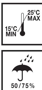
I prodotti abrasivi devono essere immagazzinati in ambiente a temperatura di circa 20°C (= 68°F) e ad una umidità relativa di circa il 65%. Evitare la permanenza degli abrasivi flessibili nelle vicinanze di fonti di calore o su pavimenti umidi.
